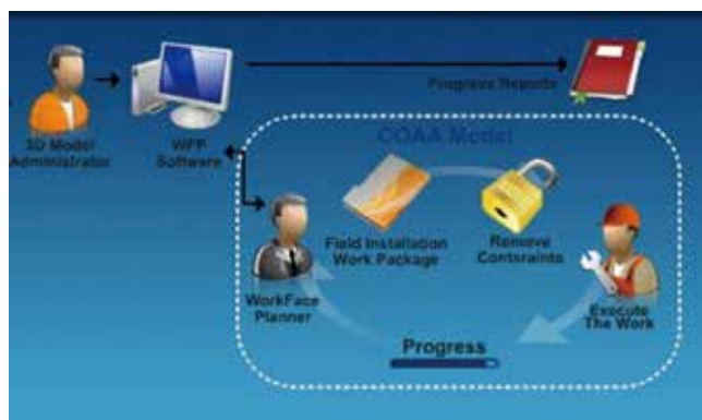
图 1 由 COAA 提出的工作面计划软件与进度反馈模型
