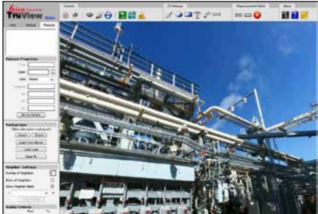
图 9 激光扫描点云和全景照片复合效果
