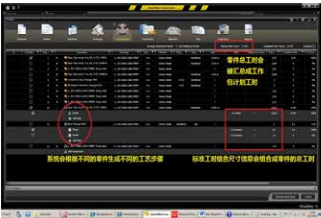
图 24 在工作包内系统自动匹配工艺步骤和工时定额
